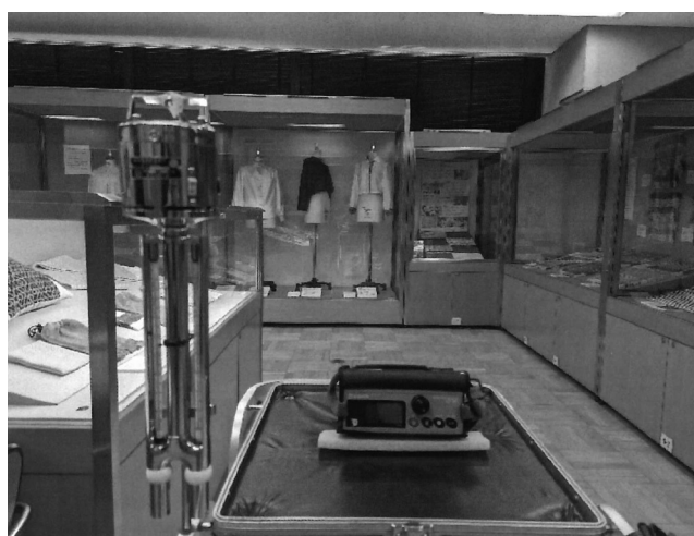
図 13 温・湿度及び浮遊粉塵量測定
